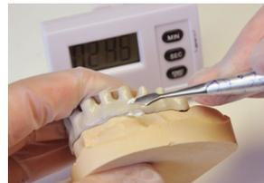
Aplicar silano sobre la superficie de titanio y dejar actuar 60 segundos. Aplicar cemento o composite de cementado sobre la estructura de Pekkton® ivory y polimerizar según las instrucciones del fabricante.
