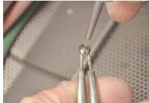
Chorrear la estructura de Pekkton® ivory con óxido de aluminio no reciclado ( $Al_2O_3$ ) con un tamaño de grano de 110  $\mu m$  y una presión de 2 bar. A continuación, limpiar con aire a presión libre de aceite o con alcohol. ¡No utilizar un limpiador de vapor!
