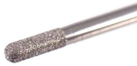
Conferir rugosidad a la superficie de Pekkton® ivory con una fresa de diamante. Emplear una velocidad de giro reducida y una presión reducida. Se recomienda una velocidad de giro de entre 5000 y 10.000 rpm. Limpiar con alcohol.
