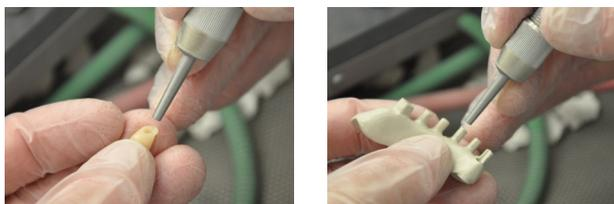
Chorrear los dientes artificiales con óxido de aluminio no reciclado ( $Al_2O_3$ ) con un tamaño de grano de 110 µm y una presión de 2 – 3 bar. Chorrear las estructuras de Pekkton® ivory con óxido de aluminio no reciclado ( $Al_2O_3$ ) con un tamaño de grano de 110 µm y una presión de 2 bar. A continuación, limpiar con aire a presión libre de aceite o con alcohol. ¡No utilizar un limpiador de vapor!
