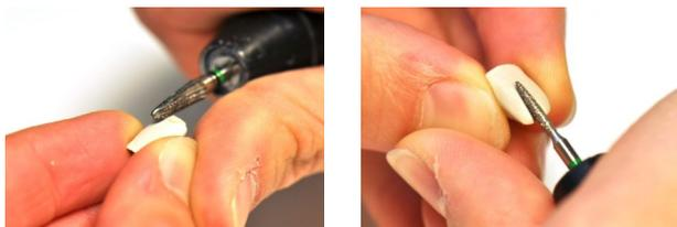
Mediante fresas de dentado cruzado se le confiere la forma definitiva a la estructura. El repasado se realiza a 5000 - 10.000 rpm como máximo. No trabajar con una presión demasiado elevada sobre el objeto. Antes del chorreado, se crea rugosidad en la superficie con ayuda de una fresa de diamante. Limpiar con alcohol.
